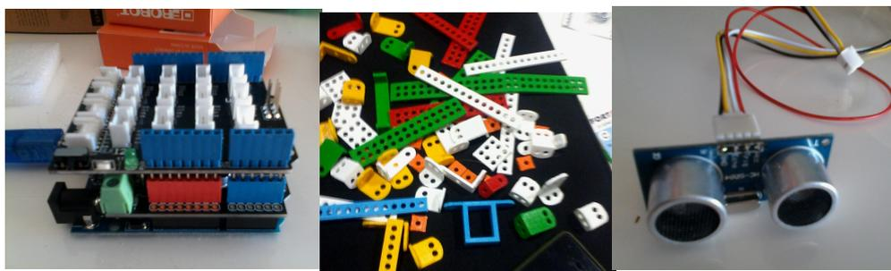
Estes componentes permitem construir vários modelos de robots e com objetivos diversos, conforme os sensores utilizados.
